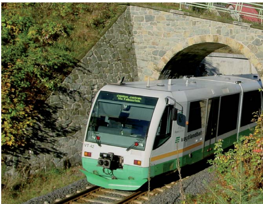
V Německu vyrobený vlak RegioSprinter je nízkopodlažní, a tudíž vhodný i pro vozíčkáře. Foto: Milan Hrudka
